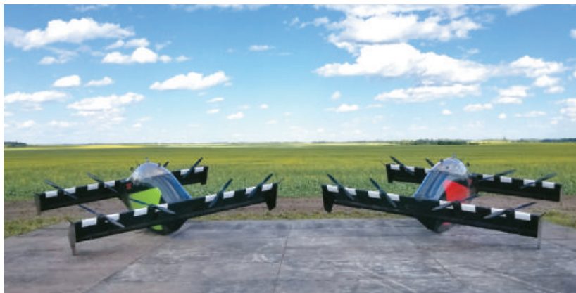
全球首見的超輕型電動定翼機「黑蠅」（BlackFly），能如同直升機般在有限空間垂直升降，並少了昂貴、耗能、噪音過大等缺點。
