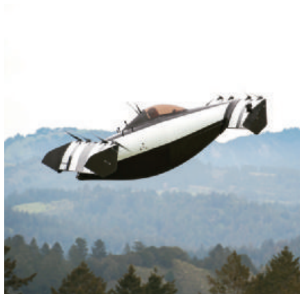
全球首見的超輕型電動定翼機「黑蠅」（BlackFly），能如同直升機般在有限空間垂直升降，並少了昂貴、耗能、噪音過大等缺點。
