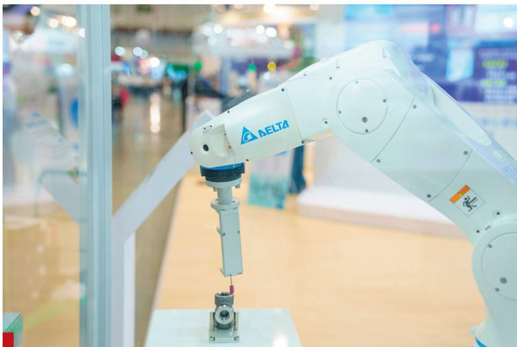
台達電針對產業升級需求，開發出智能製造解決方案，以及整合式的edgeMES製造營運管理系統，圖為電子組裝行業的六軸機器人精細打磨方案。
