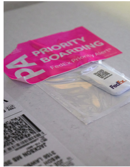
(左) 各種溫度控制解決方案將協助疫苗遞送，並安排專門的醫療團隊支援疫苗與生物科學相關醫材的運送。(右) 疫苗貨件中會安裝低功耗的藍牙感測設備FedEx SenseAware ID，能近乎即時地追蹤疫苗位置。
